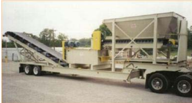
Foto 5: Equipo para tratamiento de estabilización/solidificación en operación continua tipo pac mill.
