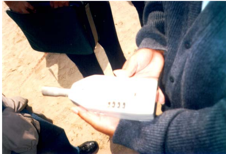
MEDICIÓN DE LOS NIVELES DE PRESIÓN EN EL POLÍGONO, UTILIZANDO UN SONÓMETRO
